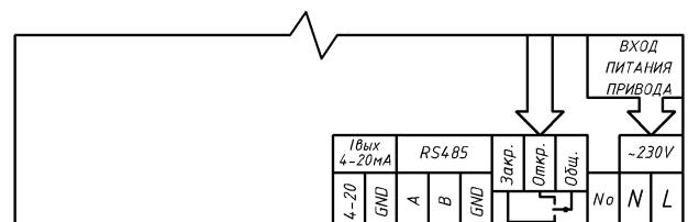
Механизм с дополнительными функциями датчика положения и интерфейса (исполнение 04)
