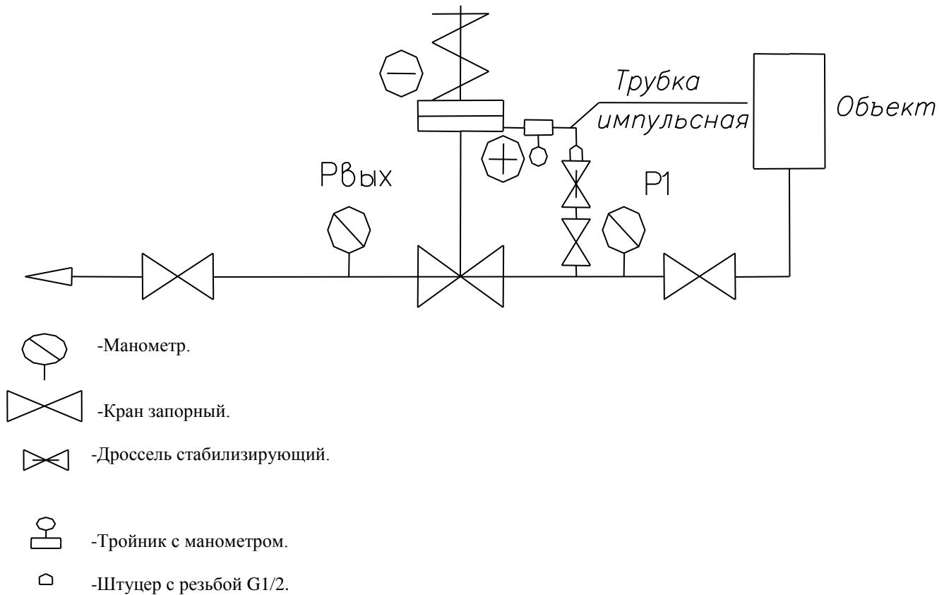
Рисунок 1. Схема подключения регулятора давления «до себя».
